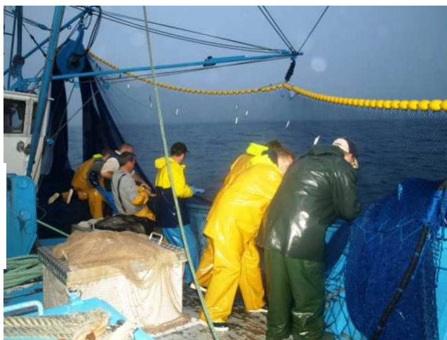
La toile et la ralingue flottante sont virées et rangées au fur et à mesure. Photo : S. Lecerf.
