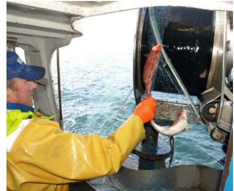
Relevage des filets grâce au vire-filet. Photo : S. Lecerf.
