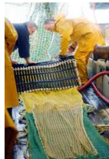
Grille de 13 mm, mailles carrées langoustine (devant), mailles carrées merlu (au fond). Photo : L. Flageul.
