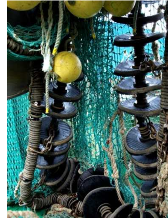
Bourrelet gréé avec des diabolos. Photo : S. Lecerf.
