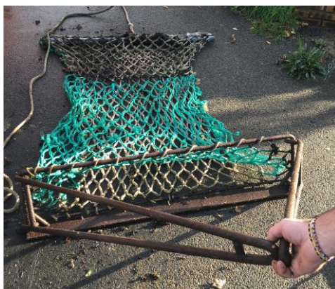
Drague à oursin utilisée sur les Glénan : armature filet
