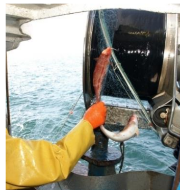
Relevage des filets grâce au vire-filet. Photo : S. Lecerf.
