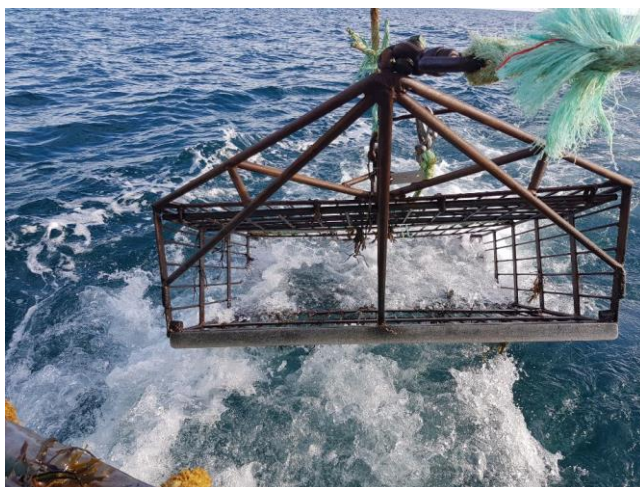
Drague à oursin utilisée sur les Glénan (armature rigide)
